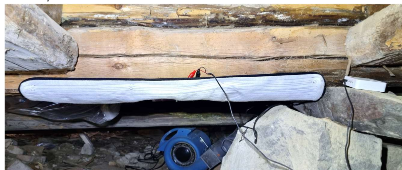
InfraVivo IR Drying Blanket - Feldtest Kriechkeller
